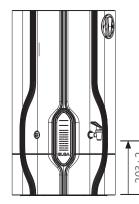
Capacity: 30 liters Dimensions (mm): 660 (h) x 376 (w) x 340 (d) Flow Rate: 8 l/min
