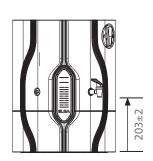
Capacity: 15 liters Dimensions (mm): 470 (h) x 376 (w) x 340 (d) Flow Rate: 6 l/min
