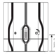
Capacity: 60 liters Dimensions (mm): 570 (h) x 532 (w) x 522 (d) Flow Rate: 10 l/min
